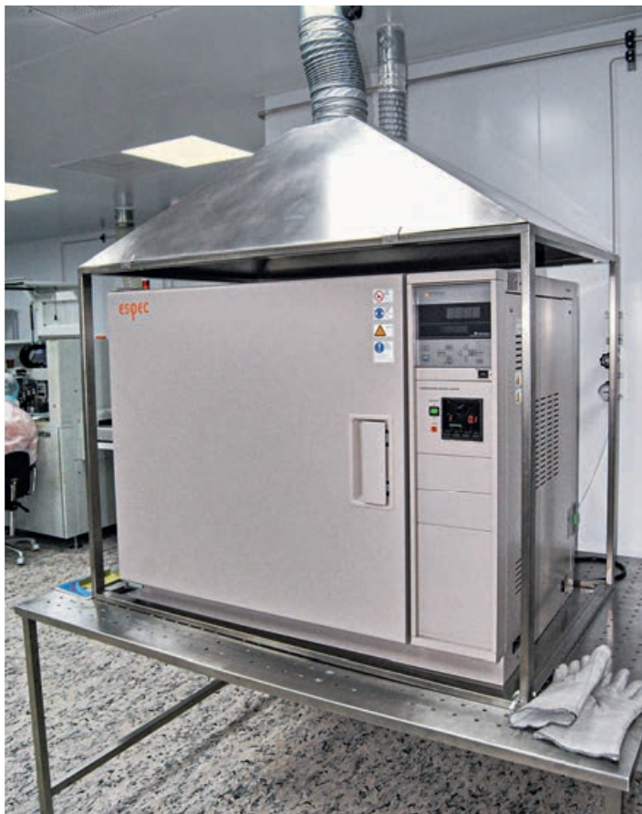
7 Шкаф сушки от компании Espec, в котором производится отверждение клея
