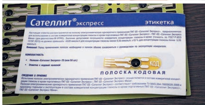
1 Групповая заготовка с кодовыми полосками (вверху) и этикетка с кодовой полоской, которая вкладывается в упаковку с тестовыми полосками (внизу)
